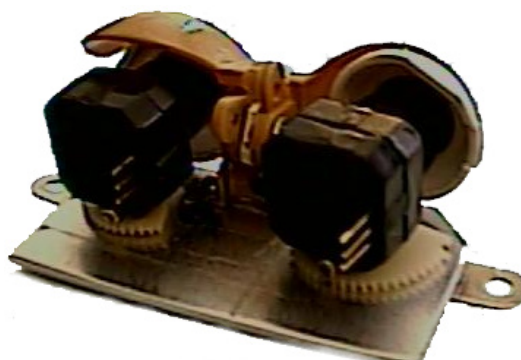
Abb. 16: Kameramodule auf Zahnräder montiert
