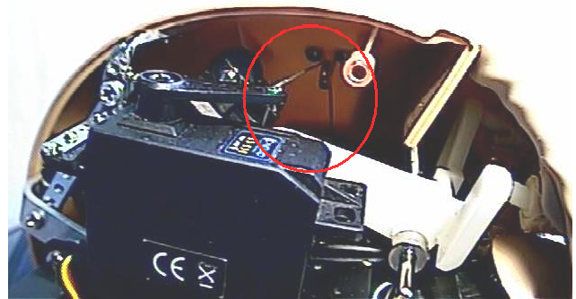
Abb. 17: Seilzug und Umlenkrolle für das linke Ohr
